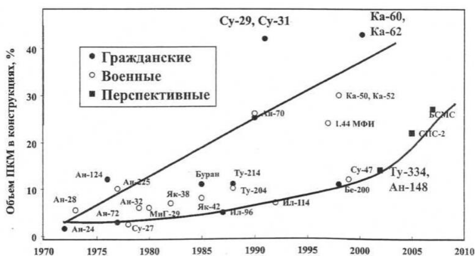
Рисунок 3 . Расширение объемов применения полимерных композитов в конструкциях авиакосмической техники.
